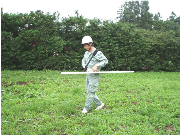
電気探査装置
