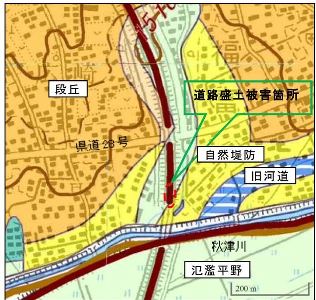
図 4.1.2 法面崩壊地点周辺の治水地形分類図 (文献 11 に加筆)
