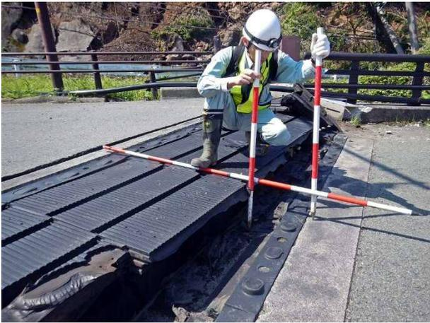
写真 4.1.32 橋桁の沈下（西側橋台部）
