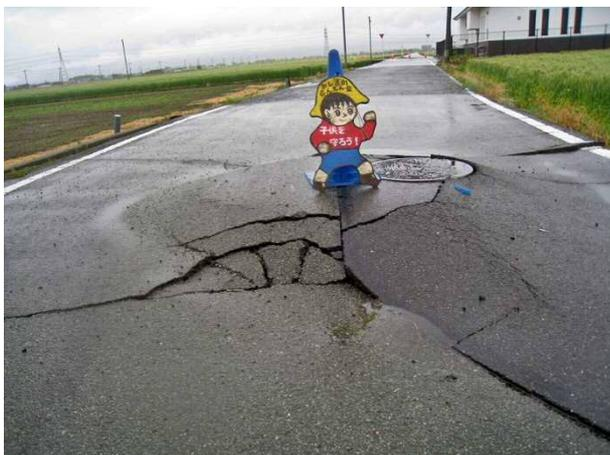
写真 4.7.39 下水道マンホールの浮き上がり
