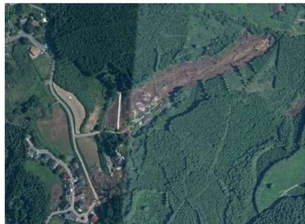
写真4.5.43 地震後の火の鳥温泉背後斜面の崩壊状況<sup>11)</sup>
