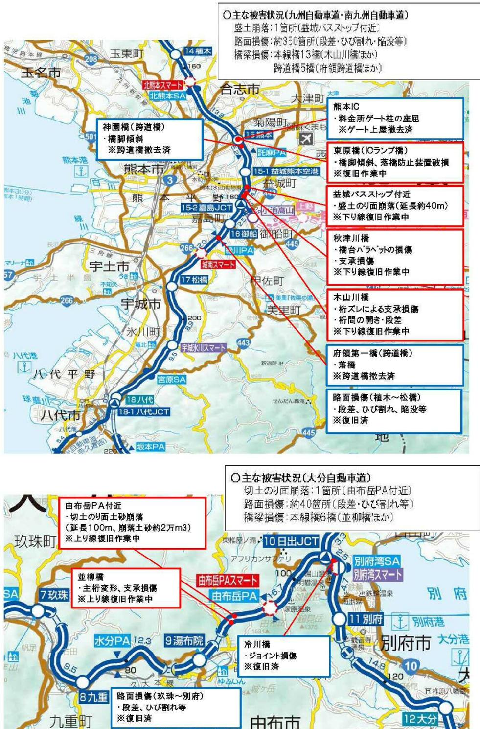
図 2.3.2 高速道路の被害と復旧状況<sup>25)</sup>
