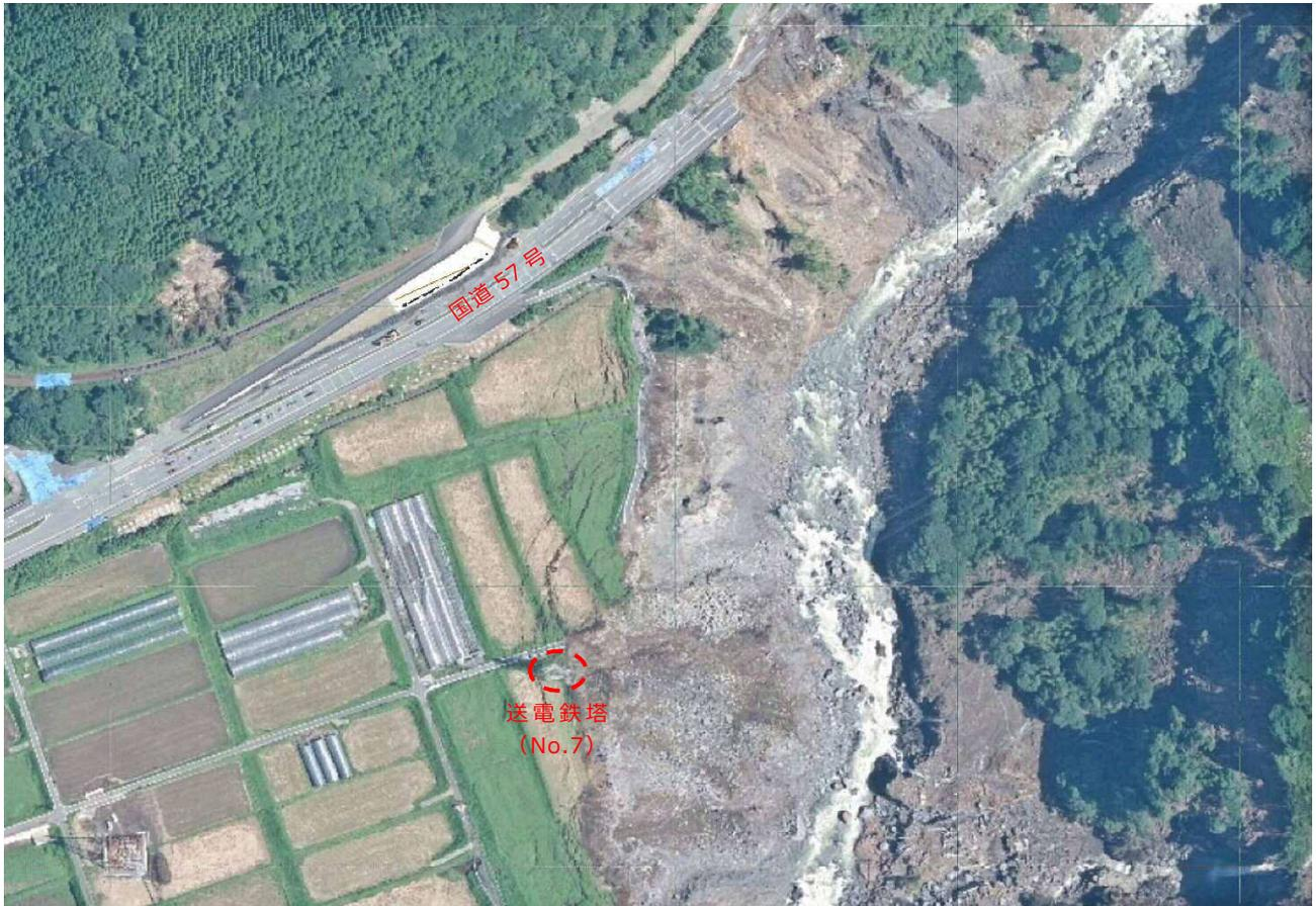
写真 4.5.11 南阿蘇村立野付近の黒川流域の斜面崩壊（文献 11（2016 年 7 月 5 日撮影）に加筆）
