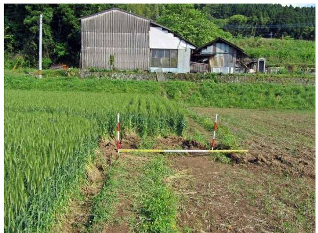
写真 1.4.8 同左 近景 2.2m の横ずれ変位(地点A)
