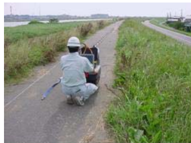
受振子を一定間隔でならべて設置し、表面波の伝播を測定する。
