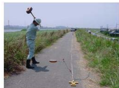
大ハンマー(木製)で地盤を強打することで、表面波を発生させる。
