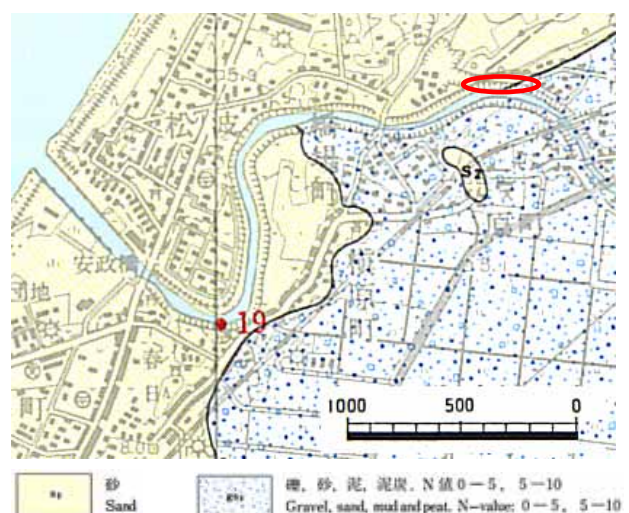
図4.1.6 道路崩壊地点近傍の表層地質 4)
