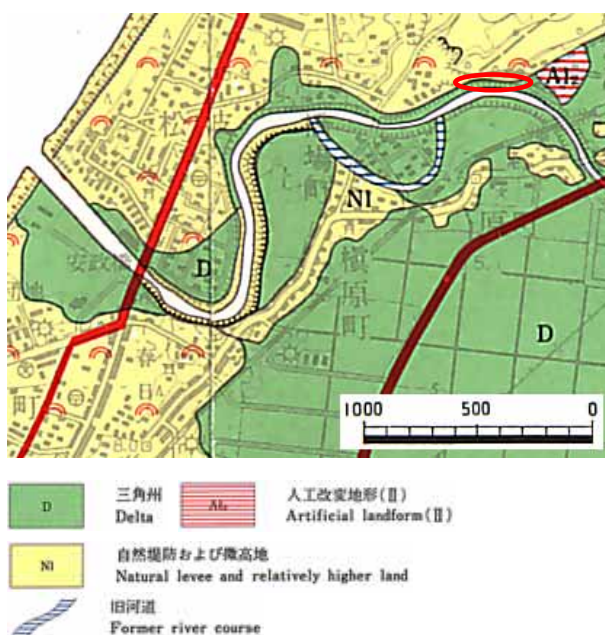
図4.1.5 道路崩壊地点近傍の微地形 3)
