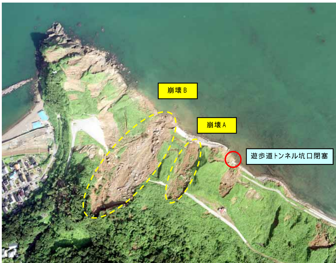
写真4.6.12 空中写真による米山町聖ヶ鼻周辺の斜面崩壊
