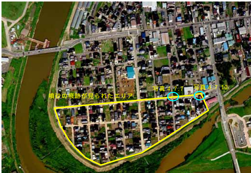
写真4.7.8 松波2丁目の航空写真 噴砂が生じた道路が黄色く見える
