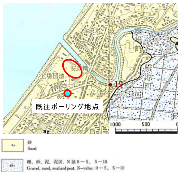
図4.5.4 浄化センター付近の表層地質 4)
