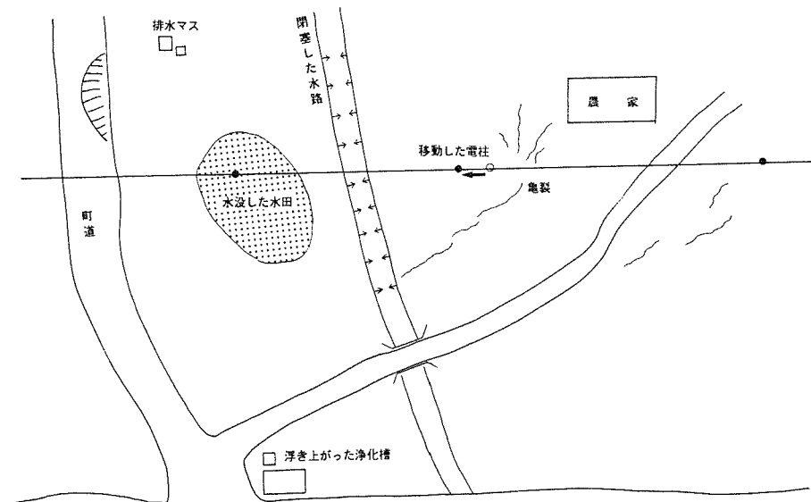
図5-1 液状化による地盤変状模式図（瀬棚町豊田地区） Location of ground failure and liquefaction
