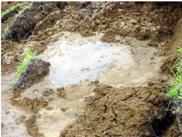
写真-4.1.4 崩壊末端部に見られた水溜まり（同上）
