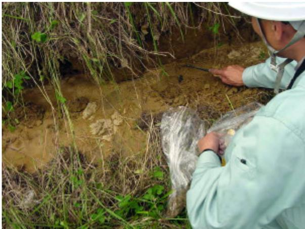
写真-4.4.8 陥没地点の噴砂（同上）
