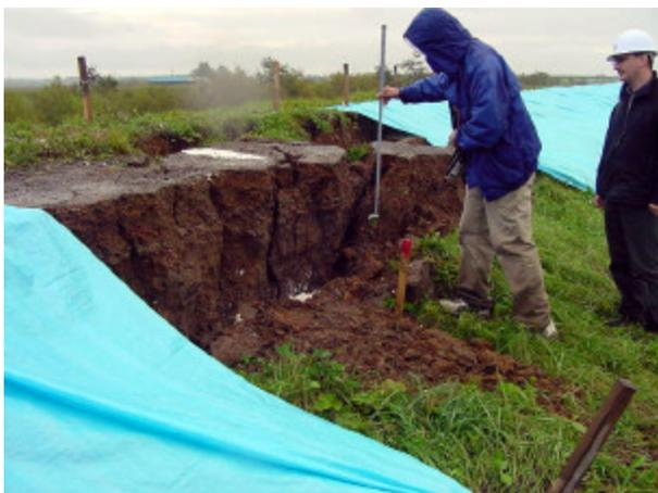
写真-4.1.22 下頃辺川右岸堤防の滑りとはらみ出し
