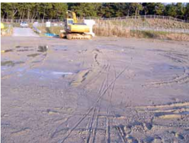
写真4.4.21 西浦漁港付近の砂浜での噴砂
