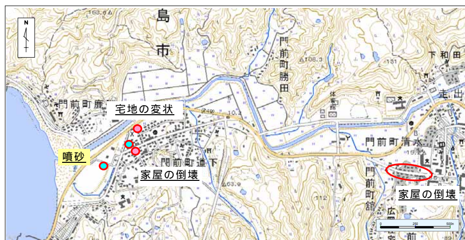
図 4.4.1 門前町周辺の木造家屋等の被災箇所
