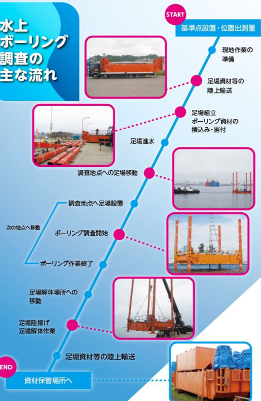
調査用鋼製檣 設置・移設状況 （起重機船による設置）
