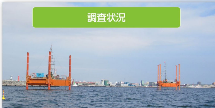
調査用スパット台船 （複数台自社保有） 適用水深：5 ～ 25m 前後
