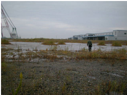
写真-4.4.1 竹内団地南部の空き地での大きな噴砂
