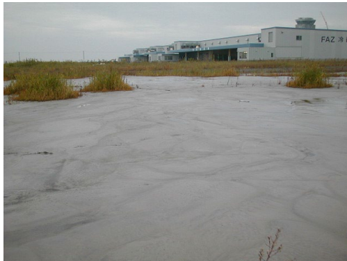
写真-4.4.1 竹内団地南部の空き地での大きな噴砂
