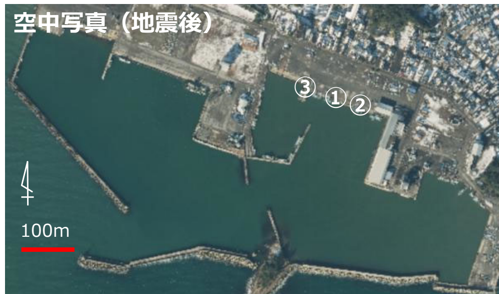
③物揚場のせり出し・沈下
