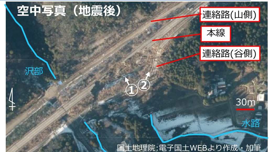
② 横田ICの本線と連絡路(谷側)の崩壊
