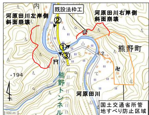
図4.5.7 輪島市熊野町・西脇町の斜面崩壊位置図(文献1に加筆、地すべり防止区域の範囲は文献25を加工して作成)
