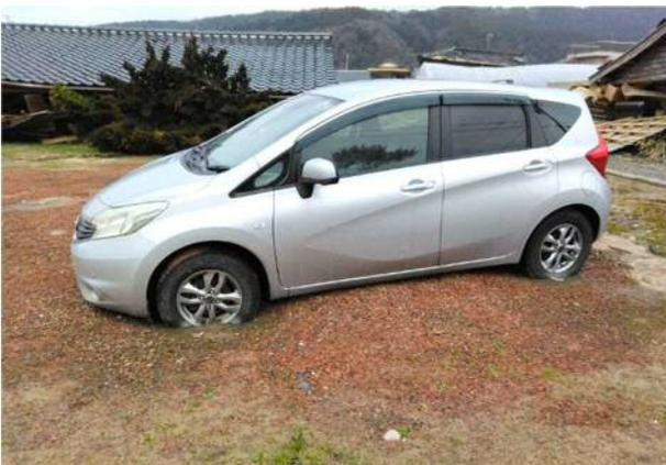
写真4.4.24 液状化によりタイヤが地面に沈みこんだ自動車
