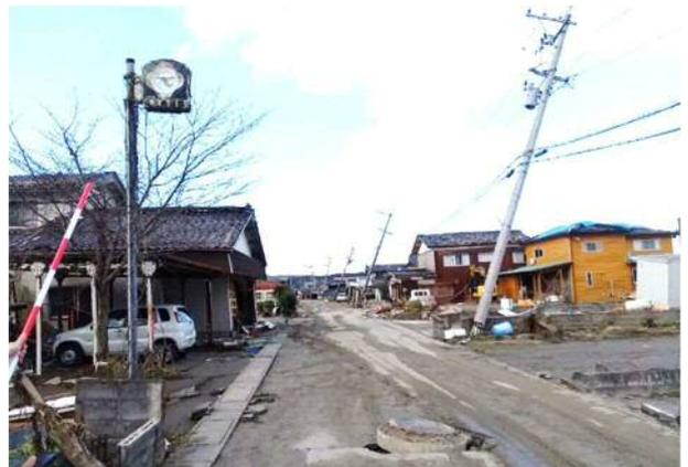
写真4.4.8 液状化による電柱の沈下・傾斜
