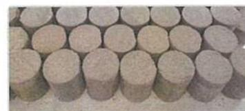
写真2: ポリマーを削り取った後の砂試料
