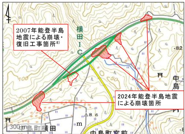
図 4.1.14 横田IC周辺の道路崩壊箇所(文献1に加筆)
