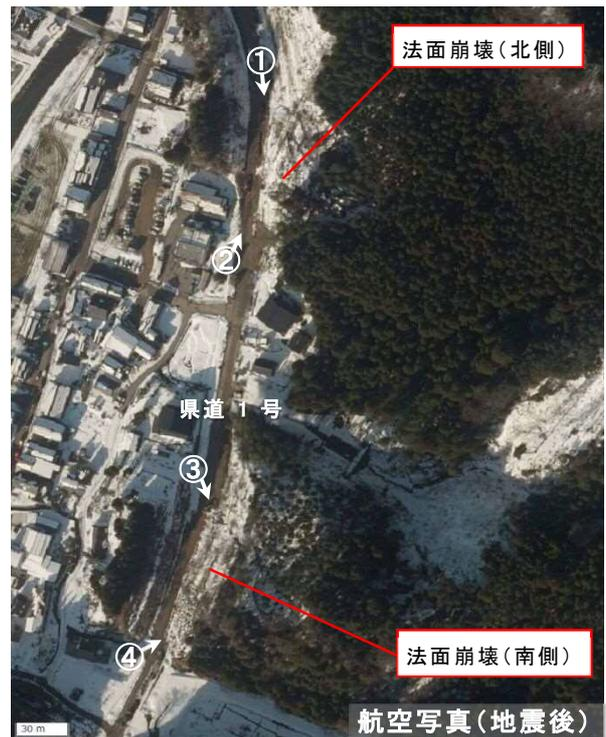
図4.5.9 輪島市三井町長沢の道路法面崩壊位置図(文献1に加筆)
