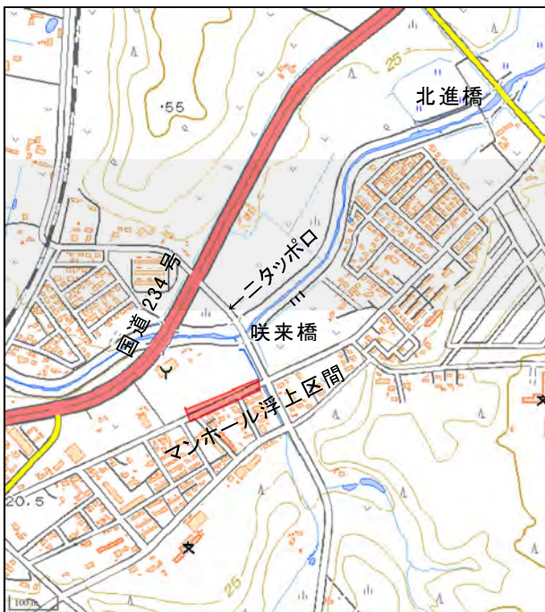
図 4.5.10 安平町早来地区の下水道マンホール変状区間（文献 5 に加筆）
