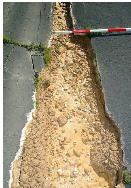
写真 4.1.20 同左開口部の近景（軽石混じりの火山灰）
