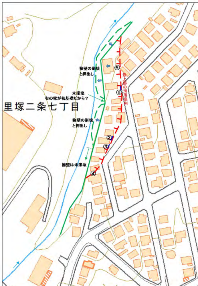
図 4.3.12 滑落崖の位置と擁壁の変状の概略図 (文献 5 に加筆)
