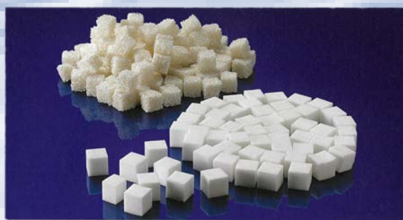
微生物固定化担体 (多孔質 PVA スポンジ)
