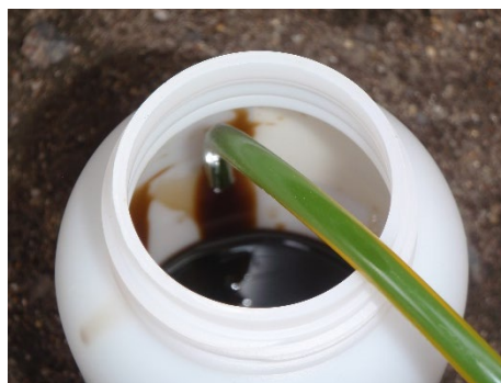
図-4 孔内油層回収装置（Kiso-ナノファイバーⅡ型）で試験回収した某工場の油
