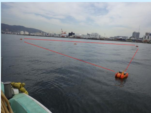
海底微動アレイ探査の測定状況
