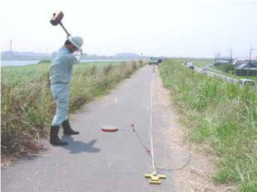
測定結果から波の周波数と伝播速度の関係を調べ、S波速度構造を求めます。縦断方向に沿って連続的に測定することで、堤防縦断のS波速度の分布が得られます。
