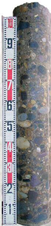
緩い礫質土 (盛土) サンプリング例 使用装置：GP-R (φ200mm)
