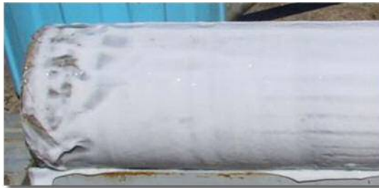
写真1：ポリマー溶液に被覆・保護された試料
