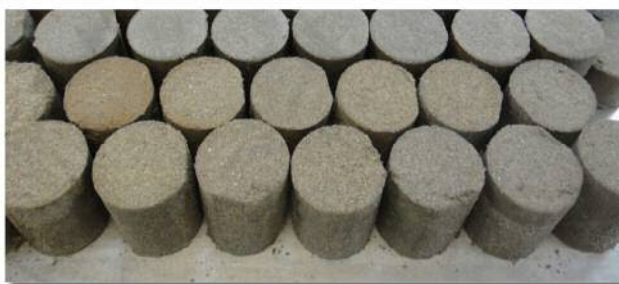
写真2：サンプルチューブから抜き出し後に自立している砂質土試料。GP-SIにて採取
