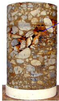
東京礫層サンプリング例 使用装置：GP-D (φ200mm)
