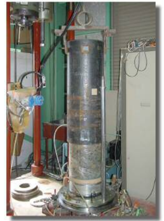
鋼製の試料運搬ケースと、試料径φ300mmの試験が可能な大型三軸試験装置
