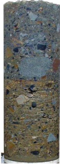
道路盛土サンプリング例 使用装置：GP-R (φ300mm)
