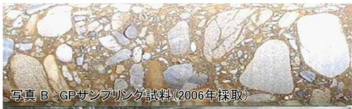
写真 4：凍結サンプリングによる試料(写真 A) と同一地点での GP サンプリング試料 (写真 B)。
