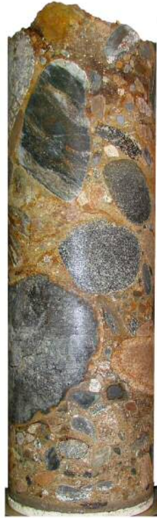
玉石混じり砂礫サンプリング例 (硬岩礫と緩い砂質土の基質) 使用装置：GP-R (φ300mm)
