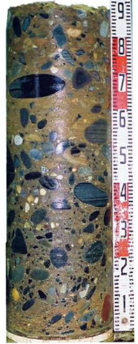
礫混じり粘性土サンプリング例 使用装置：GP-R (φ300mm)
