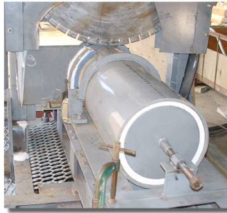
大径の保護管ごと切断可能な大型カッター。切断時の切削水にはポリマー溶液等を使用
