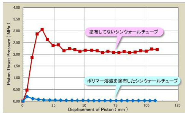
図1：サンプルチューブ内の試料を押し出す際の圧力と、押し出し機のピストンの変位量との関係
