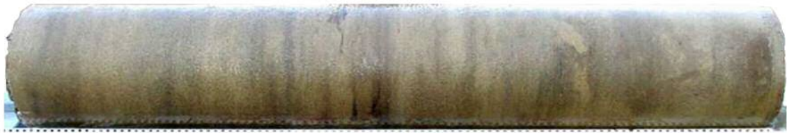
砂質土層サンプリング例 (GL-16. 10~17. 15m) 使用装置：GP-D (φ200mm)
