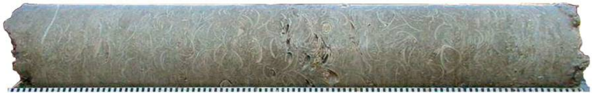
貝殻混じり砂層サンプリング例 (GL-18. 05~19. 08m) 使用装置：GP-D (φ200mm)
