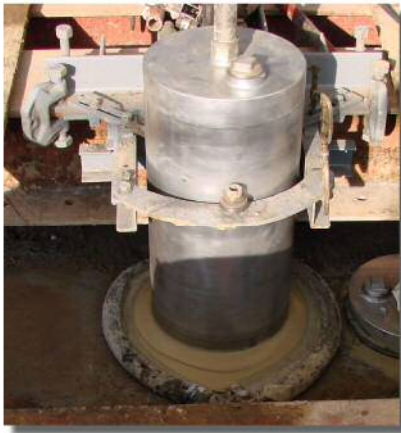
高速回転時の軸ブレを防ぐGPサンプラー専用スタビライザー
