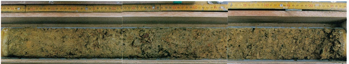
旧地すべり性崩積土(GL-9.00~10.00m)
