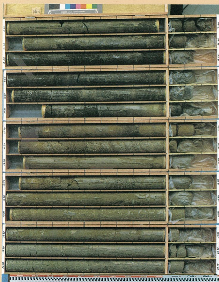
トリプルチューブサンプラーによって採取された乱されない試料
