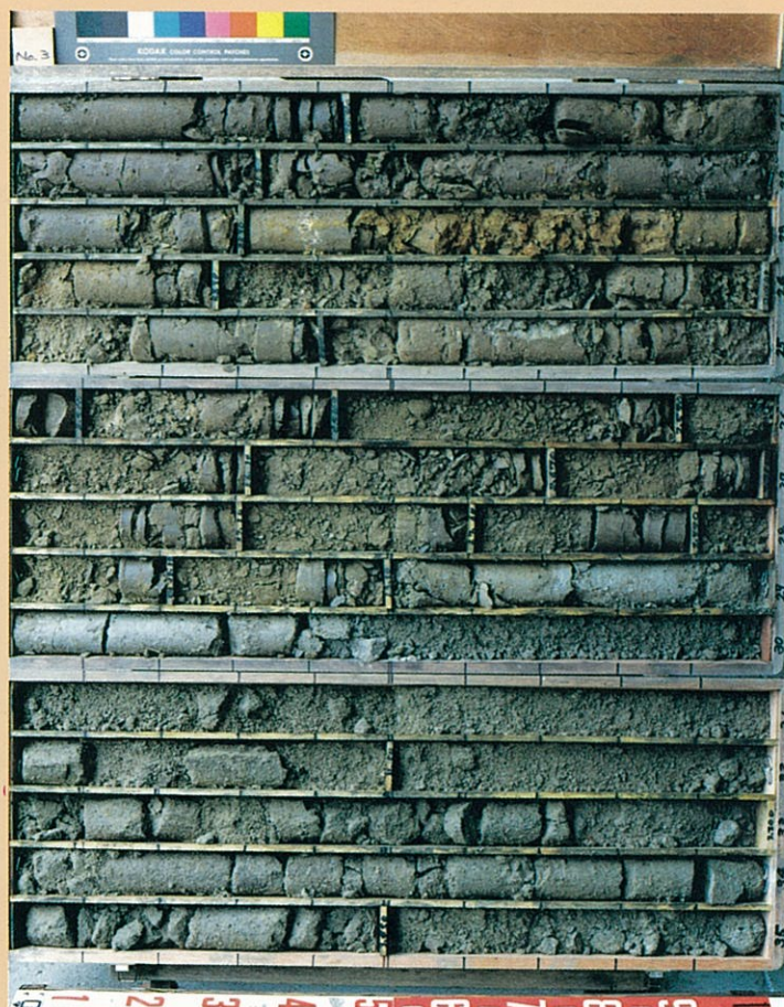
コアボーリング(普通工法)によって採取されたコア試料
