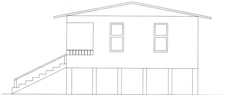
図7.1 高床式木造家屋の模式図
