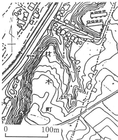
図9.3 材木町崩壊地付近の造成前の地形図（1956年釧路市都市計画現況図、1/3,000）
