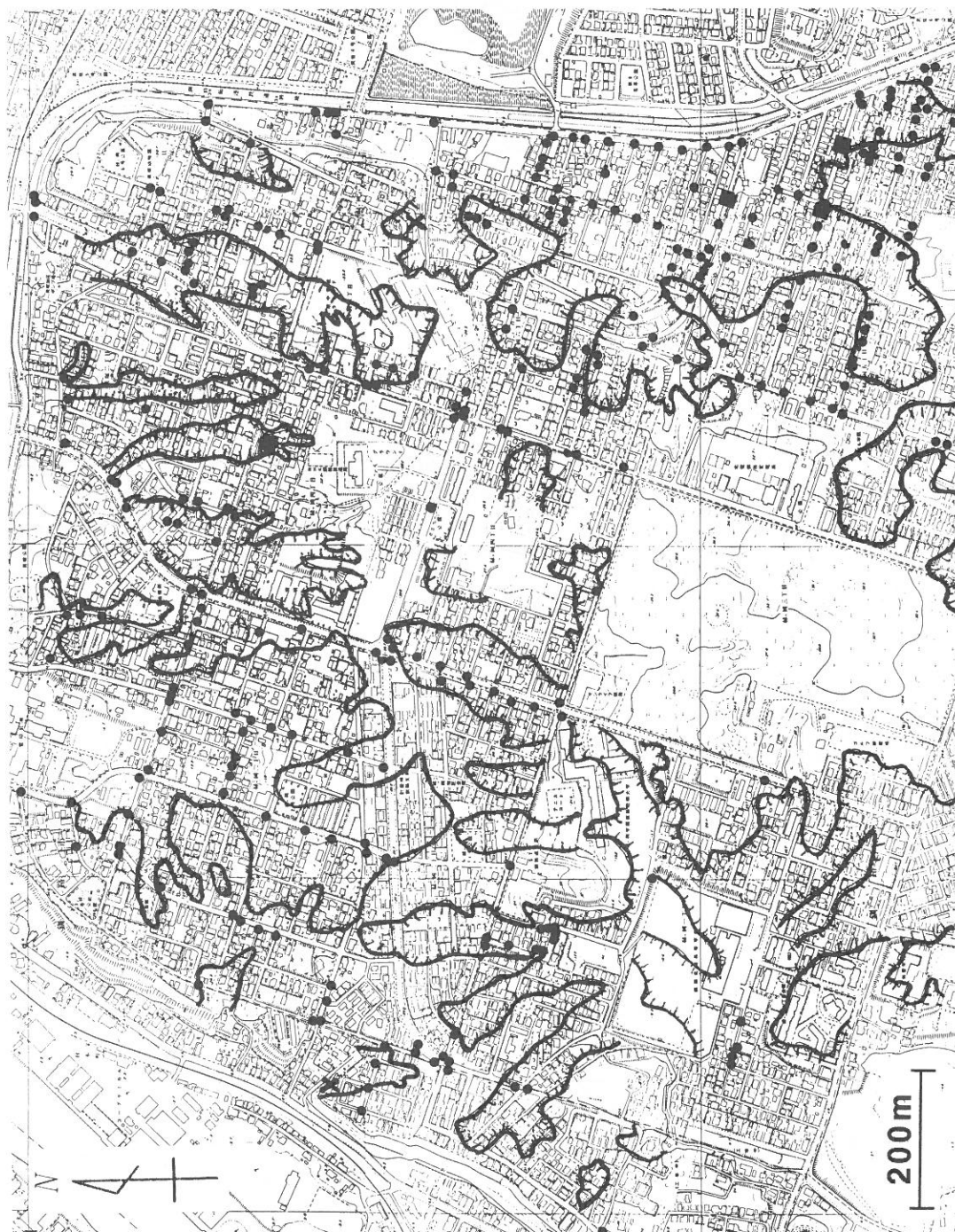
図9.15 緑ヶ岡地区における切り盛りの境界とガス管修理時の掘削地点 11)
