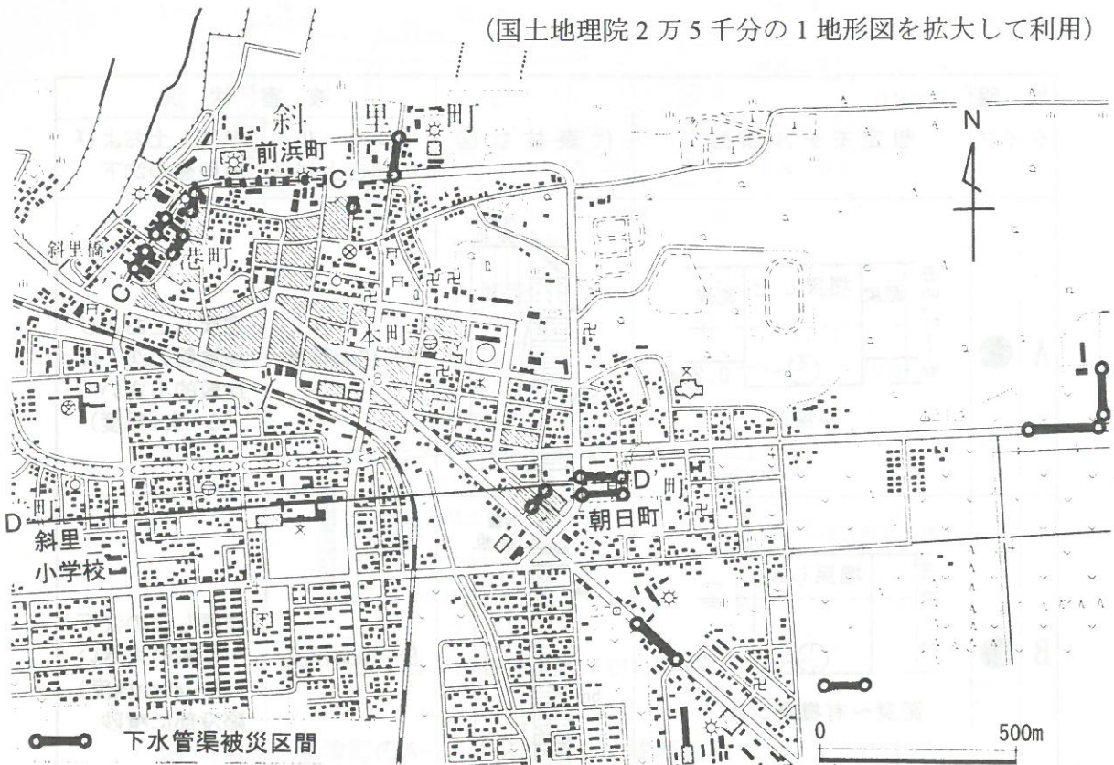
図-10.33 斜里町における下水道管渠の被害箇所 (斜里町 6) による)
