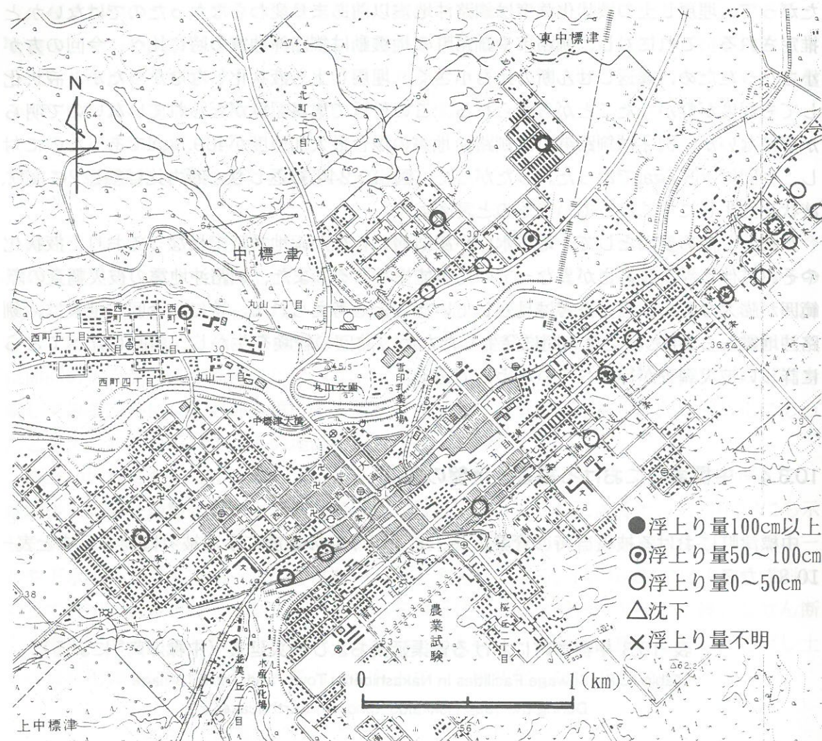
図-10.25 中標津町における下水道管渠被害箇所(中標津町 4) による)
