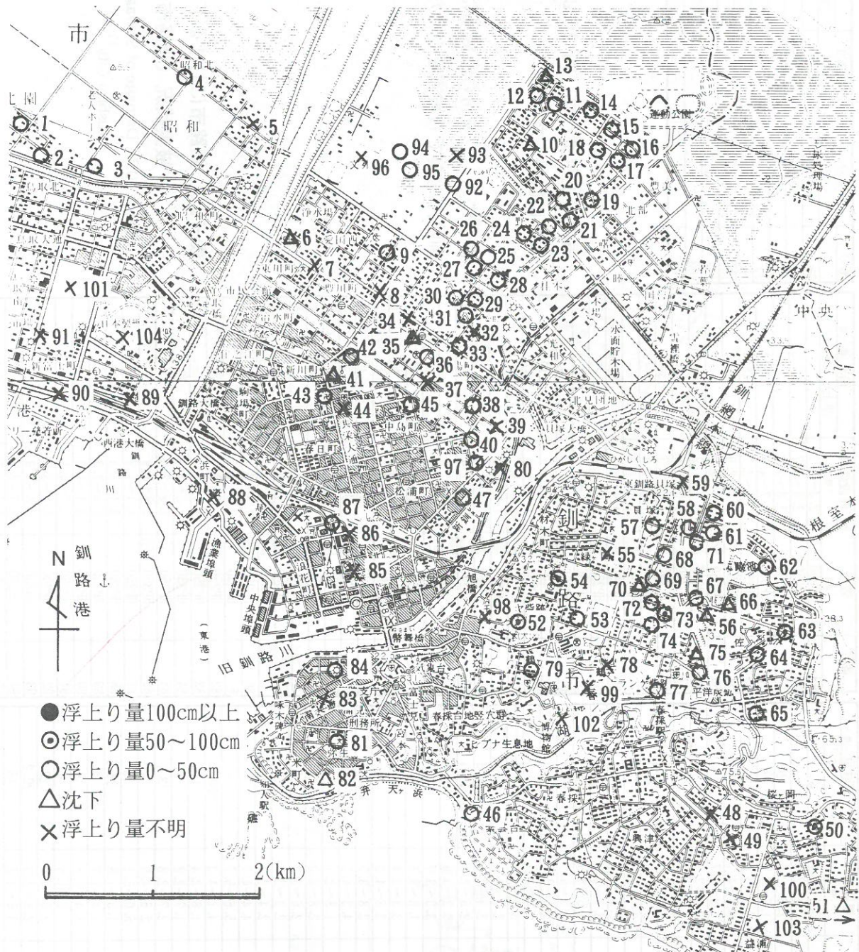
図-10.21 釧路市における下水道管渠被害箇所 (釧路市 1) による)
