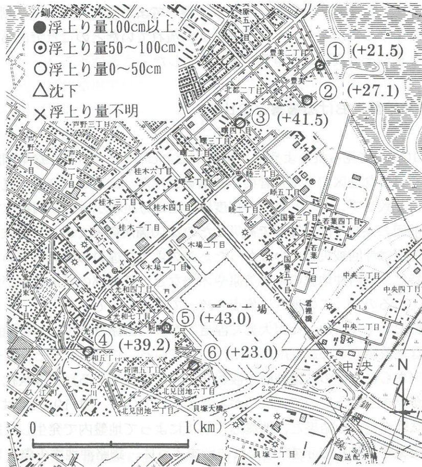
図-10.22 釧路町における下水道管渠被害箇所（釧路町 7) による) (Fig.10.22 Locations of Damaged Sewage Pipes in Kushiro Town 7) )
