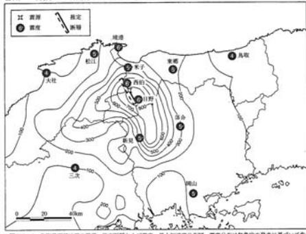
図子4-2 鳥取県西部地震の震源、震定断層および震害・最大加速度分布図。震害分布は地震庁の発表に基づいて作成した。コンターは防災科学技術研究所が公表した最大加速度分布図を転写したもので、単位はガル。震源および震定断層は国土地理院発表に基づいて作成した。[震害総論執筆委員会による]
