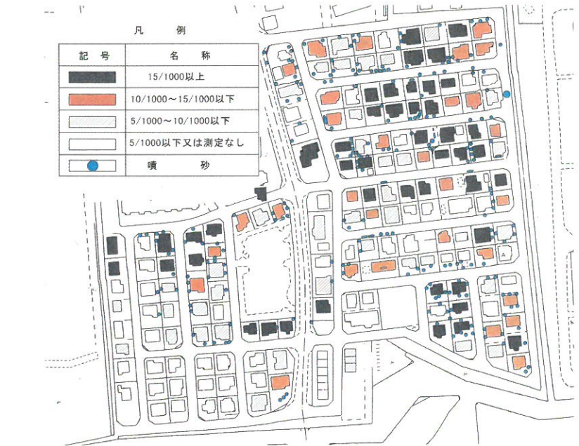
図1 安倍彦名団地内の被害状況 2)
