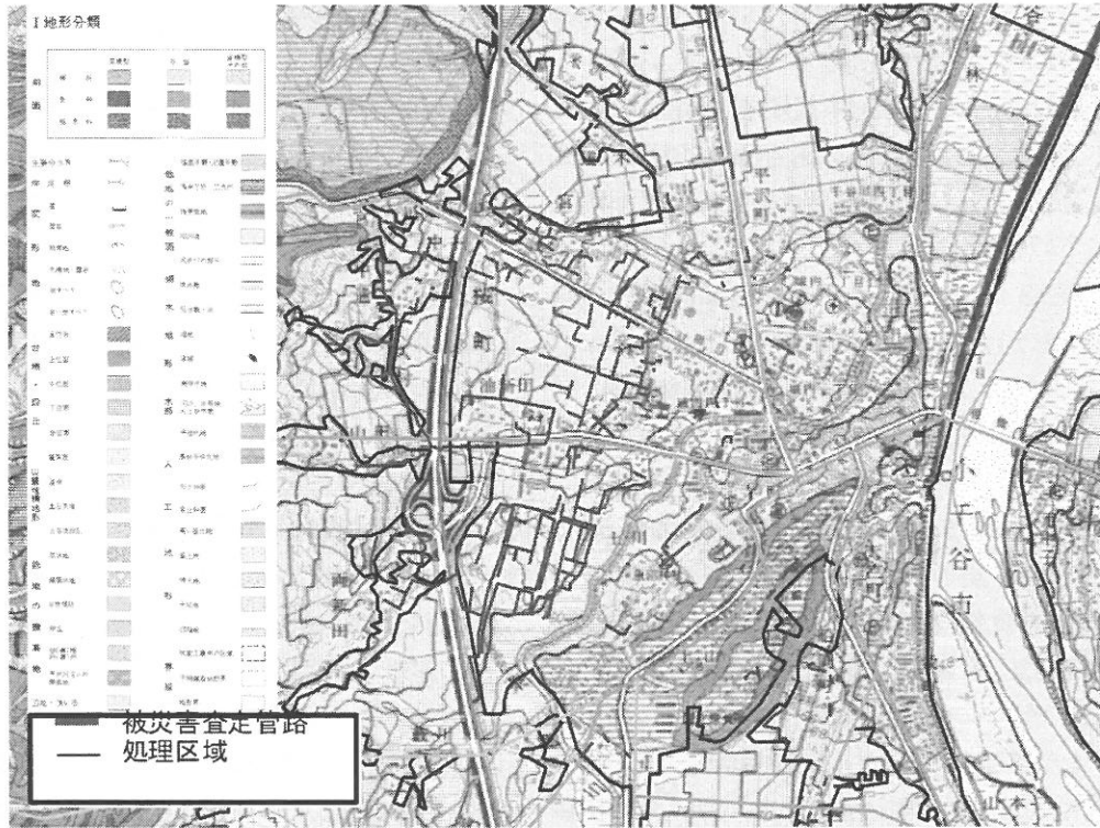
図-13.47 新潟県中越地震（小千谷）による被害路線 24) （国土地理院の1/25,000土地条件図上に描いたもの）
