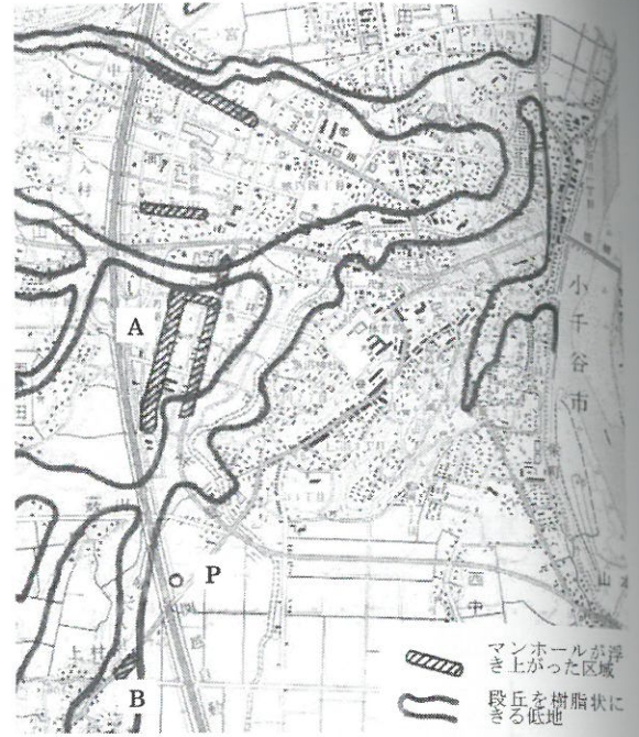
図-13.22 小千谷市若葉付近でマンホールの浮上が見られた区域と段丘に樹脂状にはいつている低地（文献 18) をもとに描いたもの）、およびボーリング位置（基図は国土地理院の 1/25,000 地形図による）
