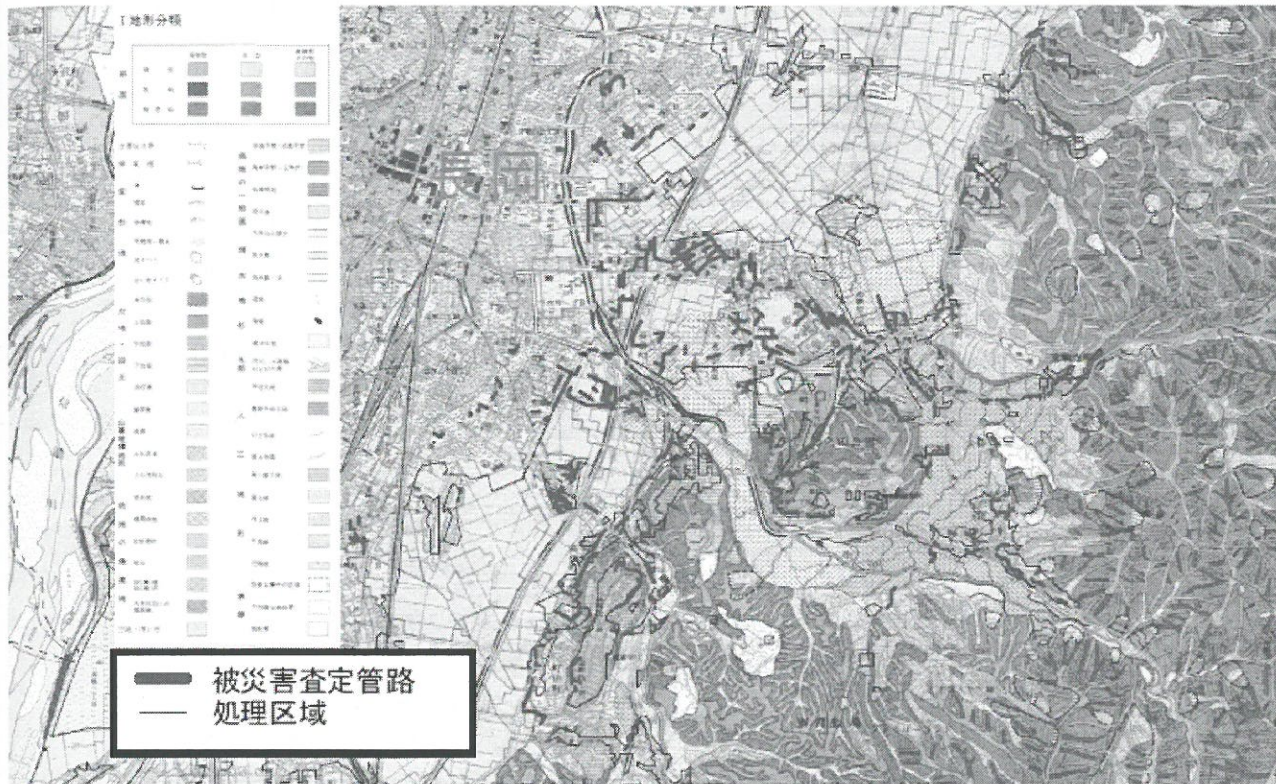
図-13.16 長岡市中心部の下水道被害分布（国土地理院の1/25,000土地条件図上に描いたもの 18),24)
