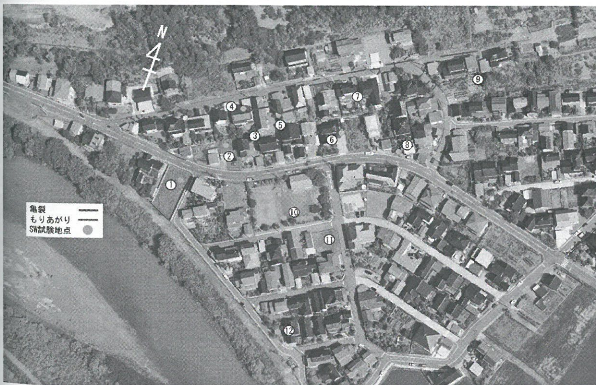
写真 3.7.1-1 山本団地の地盤変状とスウェーデン式サウンディング位置（2007年7月19日八州撮影）
