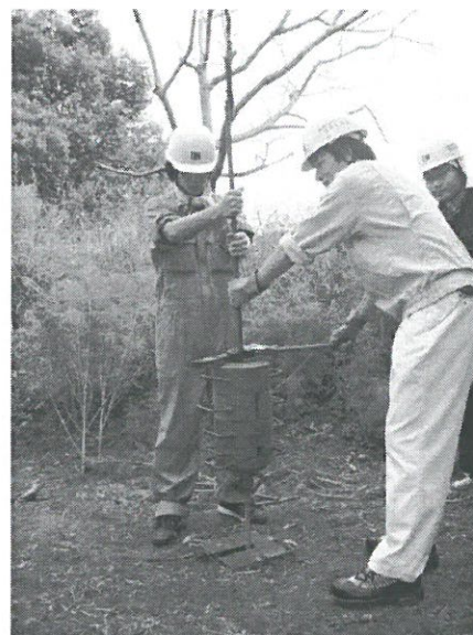
写真 3.8.1-8 試験状況 (人力による回転貫入)
