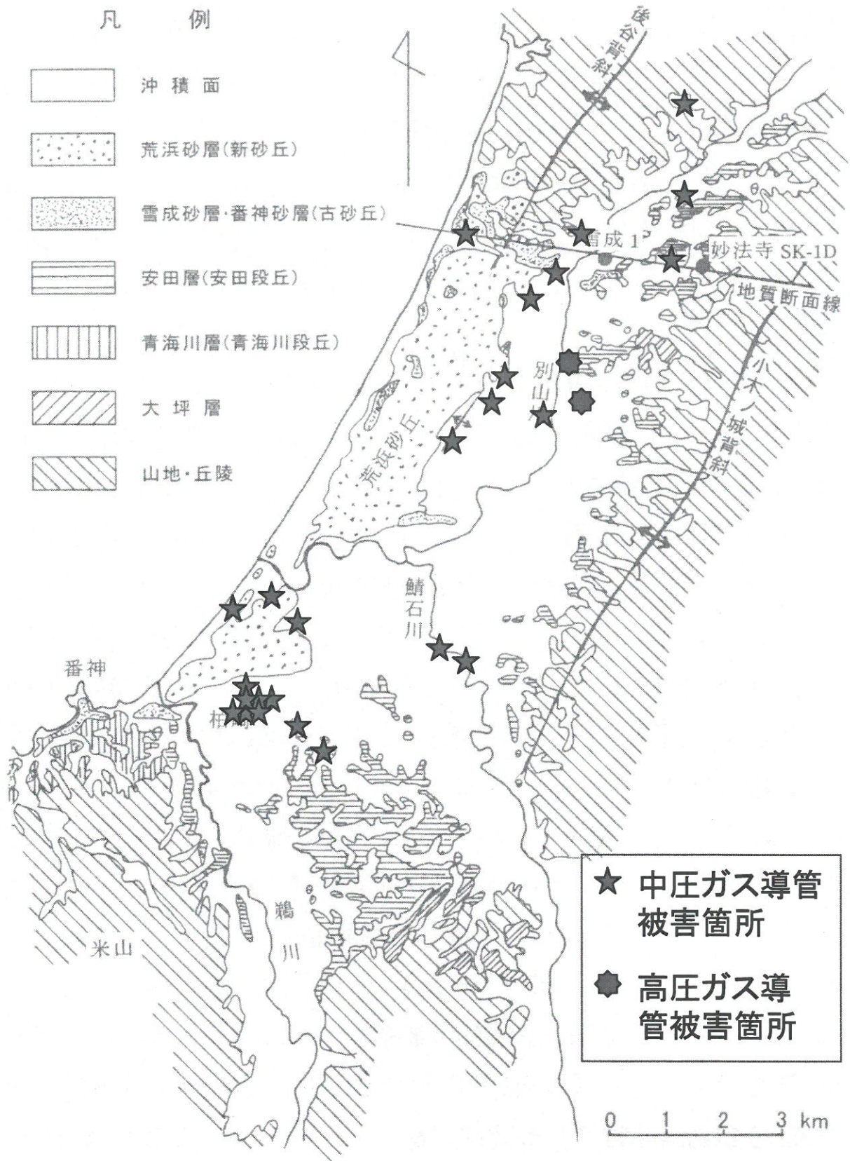
図 5.9.3-1 柏崎市・刈羽村における高圧・中圧ガス導管被害位置 (資料 1 に資料 2 による被害箇所をプロットしたもの)
