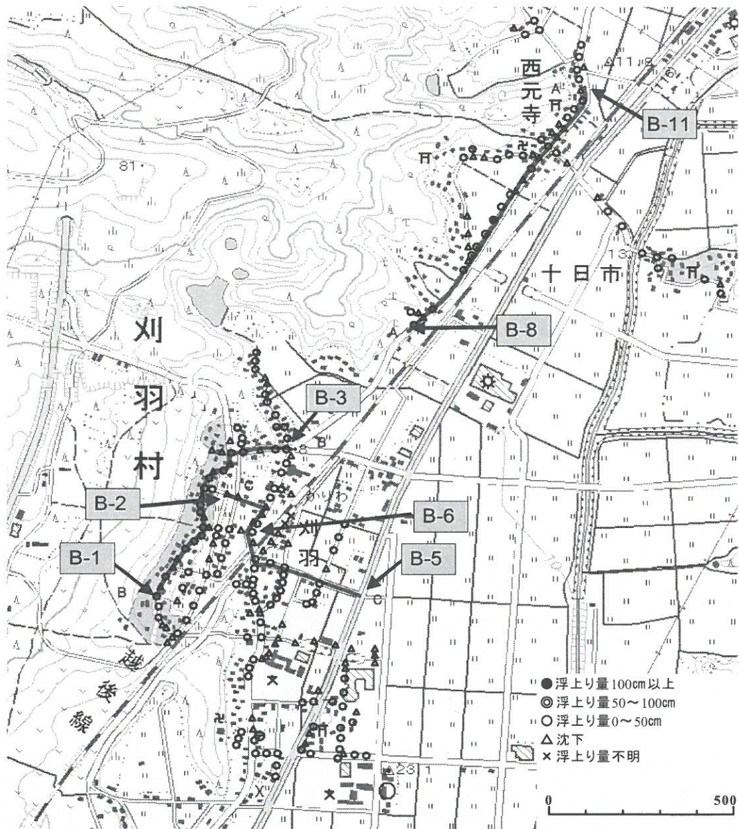
図 5.9.2-3 刈羽中央地区のマンホール浮上り量の分布と断面位置 (国土地理院の 1/25,000 地形図上に描いたもの) 3)
