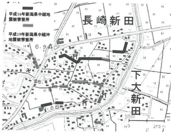
図 5.9.2-2 長崎地区における前回と今回の地震による被災区間の比較
