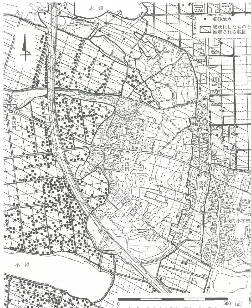
図4.10 能代市浅内地区の液状化発生地点 9)
