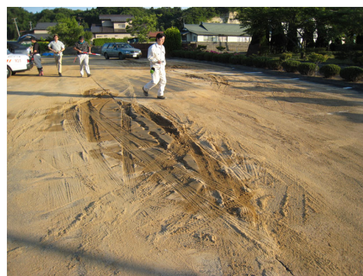
写真 1 鶯沢多目的研修センター駐車場の噴砂 （6/15 東北大渦岡撮影）
