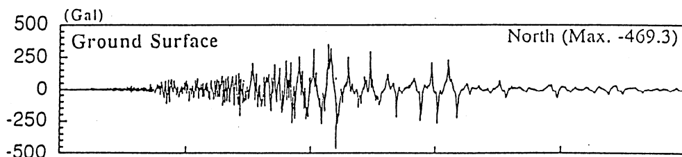
図 2.5.20 サイクリックモビリティが顕著に現れた加速度波形の例
